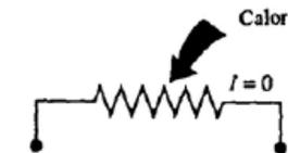
**Fig. 7-2 – Aquecer um fio condutor não faz aparecer neste uma corrente elétrica**
